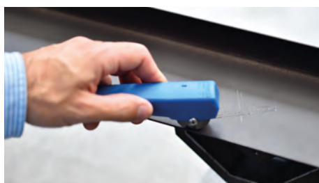
Test d'adhérence par essai de quadrillage selon la norme NF EN ISO 2409
